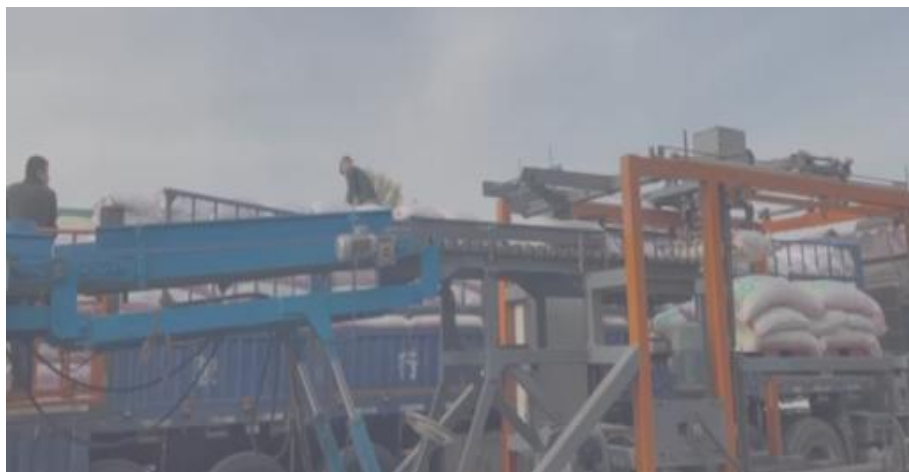
图 6-11 校企共研产品可移动式卸车码垛一体机
